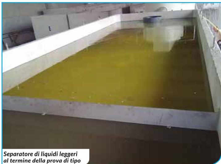
Separatore di liquidi leggeri al termine della prova di tipo
